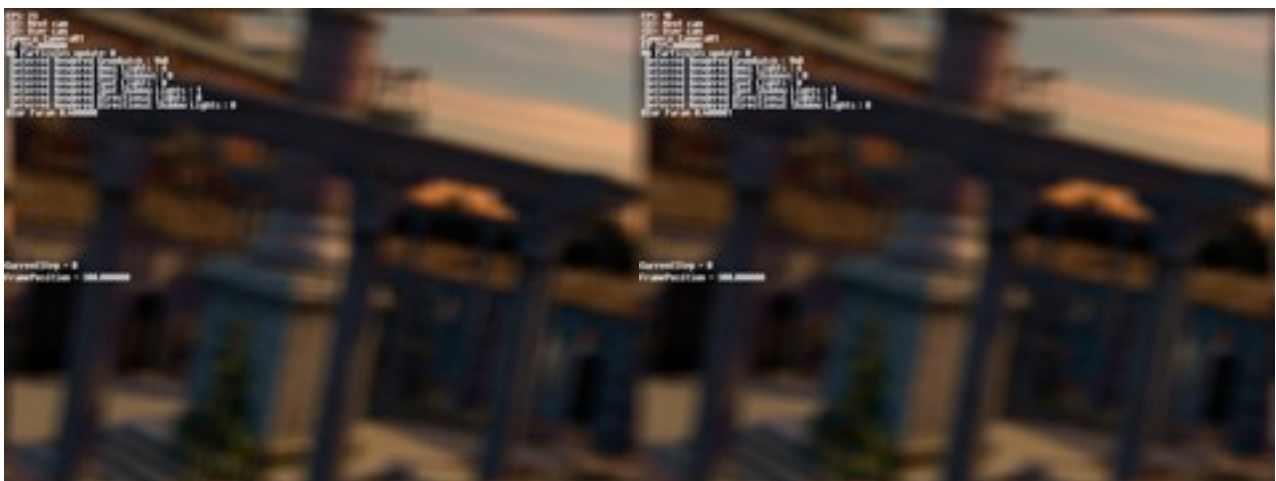
à gauche : flou sur 13 samples : 28 FPS équivaut à 35.7ms par frame à droite : flou sur 25 samples : 26 FPS équivaut à 38.4ms par frame
